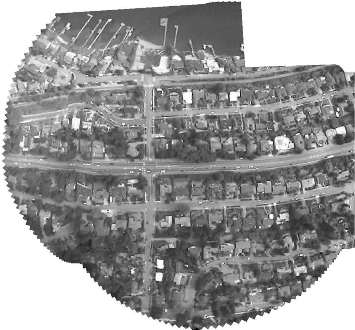
Figuur 3.23: Een panoramisch beeld geconstrueerd met behulp van de Kanade-Lucas-Tomasi tracker (affien bewegingsmodel).
