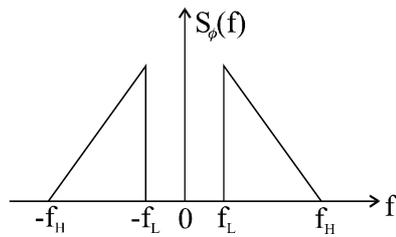
**Fig. 2 : Phase jitter spectrum**
